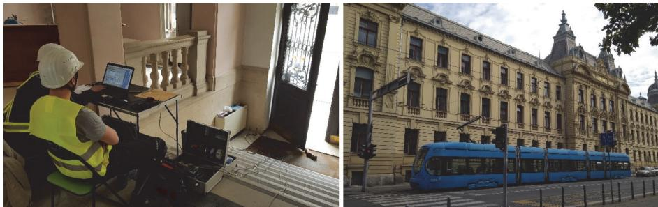
Slika 4. Preliminarni monitoring vibracija na zgradi HŽ Infrastrukture
