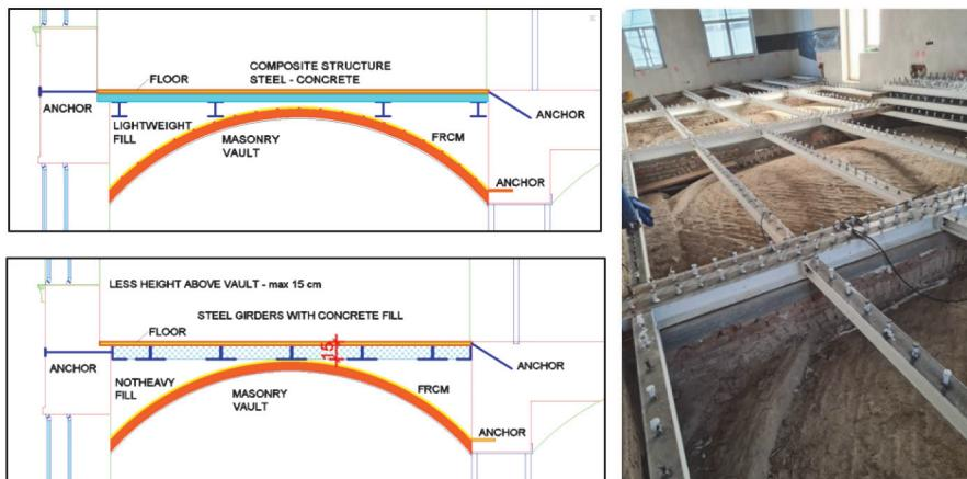
Slika 12. Izvedba spregnutog stropa čelik/beton iznad bačvastog zidanog svoda [7]
