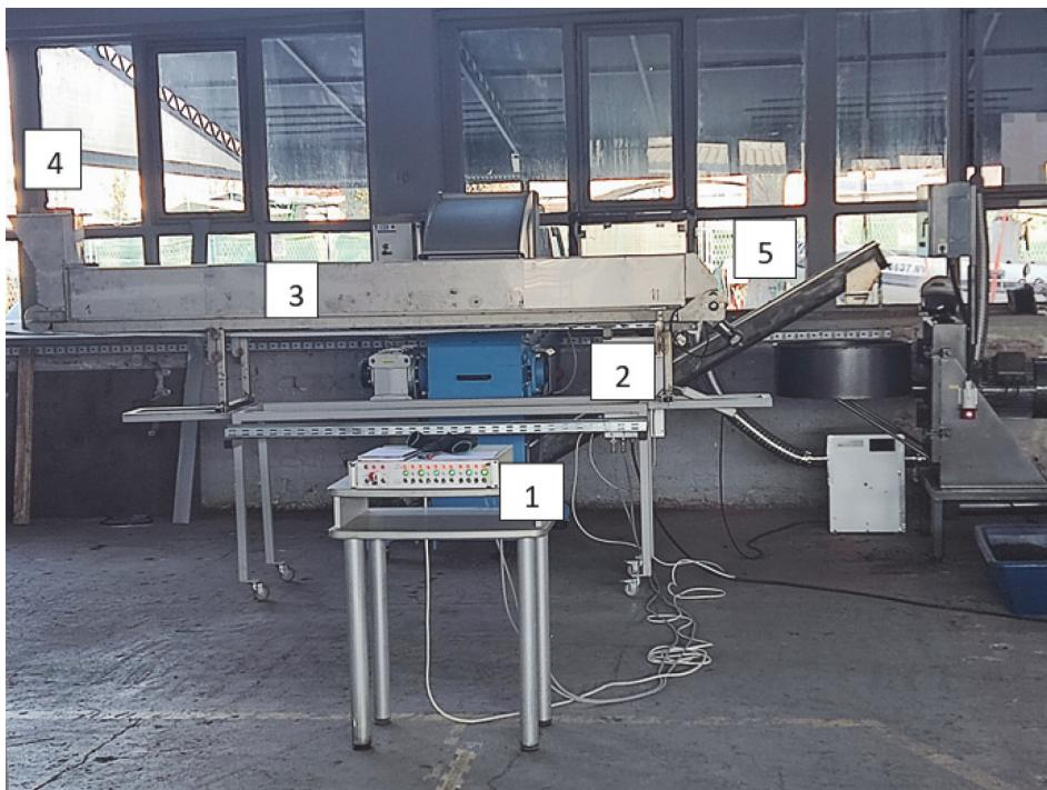
Slika 12. Pilot postrojenje korišteno za mikrovalno sušenje mulja sastoji se od sljedećih jedinica: 1) sustav upravljanja, 2) trofazno električno brojilo, 3) tunelski sušionik koji se sastoji od 11 magnetrona serijski spojenih te postavljenih po dužini tunela, 4) ventilator, 5) cijev za odvođenje kondenzata
