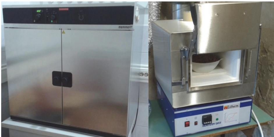
Slika 6. Korištena laboratorijska oprema u procesu sušenja i spaljivanja mulja (sušionik i električna peć)
