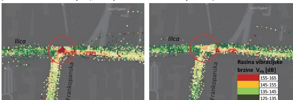
Slika 5. Prikaz smanjenja razina vibracija izmjerena na tramvajskom vozilu na raskrižju Frankopanska – Ilica prije (lijevo) i nakon zamjene križališta (desno) (izvor – arhiva GF)
