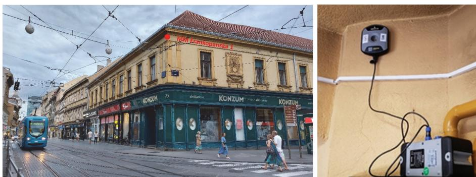
Slika 6. Mjerna lokacija na 2. etaži zgrade (Frankopanska 1) – lijevo, mjerni uređaj za monitoring postavljen na nosivi zid građevine – desno
