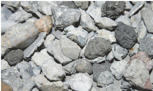
Slika 5. Reciklirani betonski agregat
