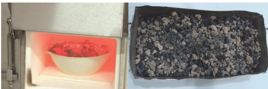
Slika 7. Užareni mulj tijekom spaljivanja i granule stvrđnutog pepela nakon spaljivanja na 850°C
