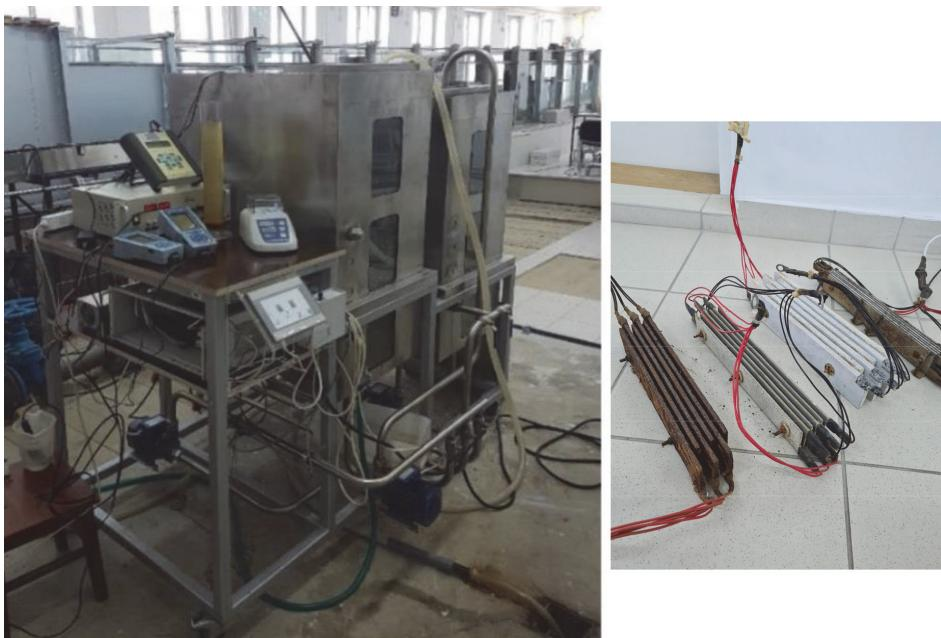
Slika 10. Pilot hibridni elektrokemijski uređaj za pročišćavanje otpadnih voda s primijenjenim elektrodama od nehrđajućeg čelika, željeza i aluminija
