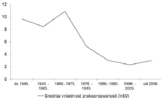
Slika 3. Prosječne vrijednosti zrakopropusnosti za neobnovljene stambene jedinice u RH prema razdobljima izgradnje [18]
