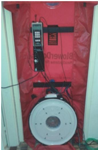
Slika 6. BlowerDoor ispitni uređaj s manometrom DG-700
