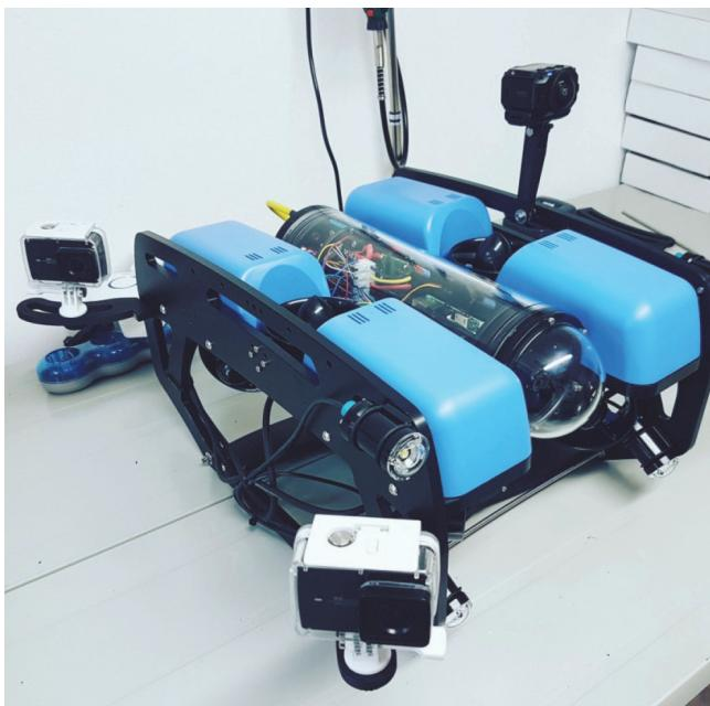
Slika 13. ROV s ugrađene četiri visokorazlučive kamere i sfernom 360 kamerom
