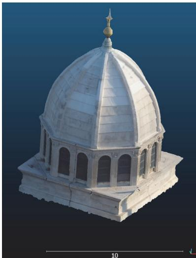
Slika 5. Kalibrirani oblak točaka točnosti 2 mm izrađen bespilotnom letjelicom
